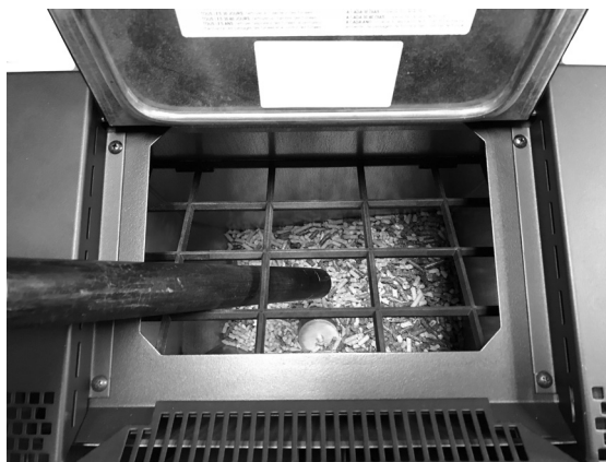
Fig. 32 - Pulizia serbatoio e coclea
