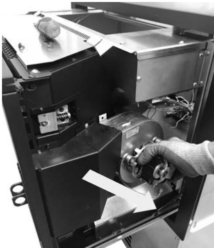
Fig. 96 - Remove the fan
