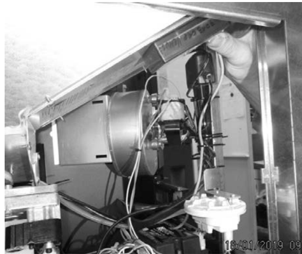
Fig. 87 - WI-FI module fixing
