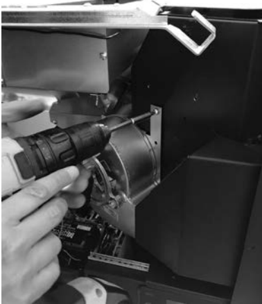
Fig. 37 - Remove the fan
