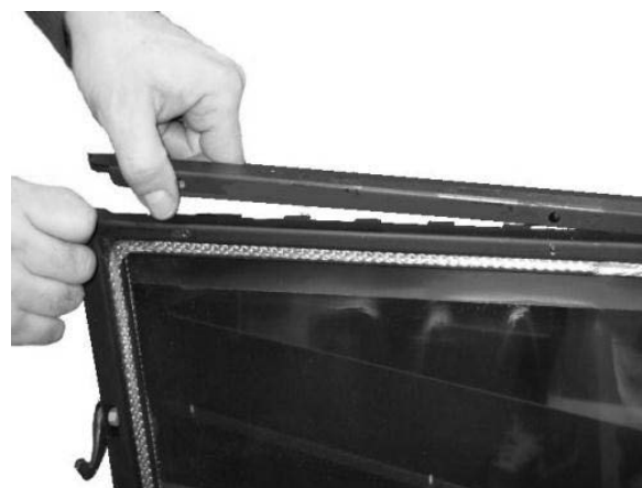
Fig. 101 - Door profiles removal
