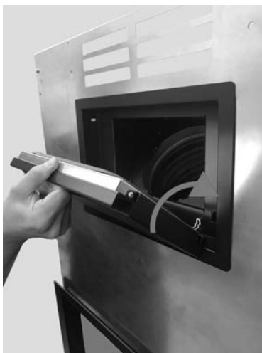
Fig. 68 - Insert the door in the trapdoor
