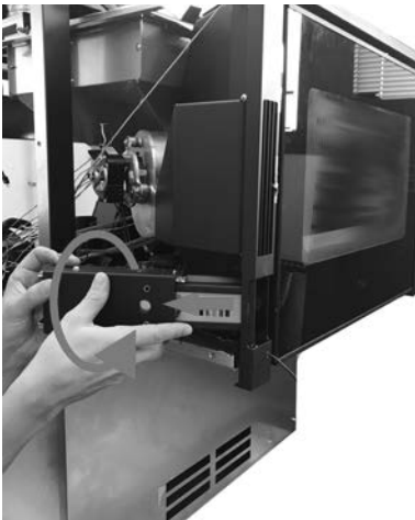
Fig. 81 - Rotate the display box
